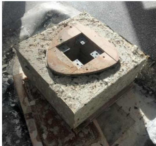
Fig. 7. Process of taking the block out of the mold - the last stage. Source: Authors' materials Ryc. 7. Proces wyciągania pustaka z formy – ostatni etap. Źródło: Opracowanie własne
