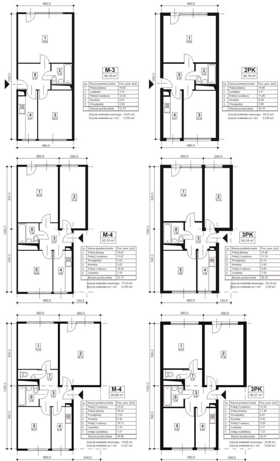
Fig. 4. Comparative analysis of construction material amount used to erect an apartment using industrialized technology (left) and traditional technology (right), and the amount of useable area in this respect. Source: G. Wojtkun Ryc. 4. Analiza porównawcza ilości materiału budowlanego użytego do wzniesienia mieszkania w technologii uprzemysłowanej (po lewej) i tradycyjnej (po prawej) oraz wielkości powierzchni użytkowej w tym zakresie. Źródło: G. Wojtkun
