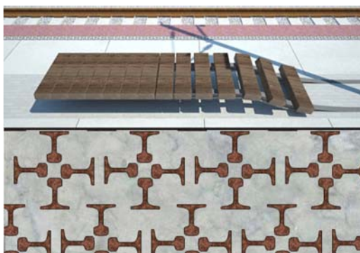
Ryc. 13. Budowanie tożsamości miast przemysłowych – projekt ławki i pasa bezpieczeństwa w nawierzchni wykonany z szyn i podkładów kolejowych. Źródło: il. Ł. Bylinka
