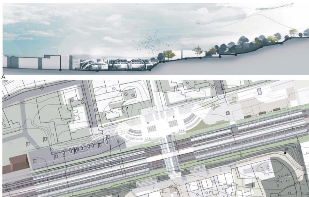
Ryc. 9. Rzut i przekrój projektowanego przejścia nad torowiskiem. Źródło: il. S. Holotovsky, 2016.
