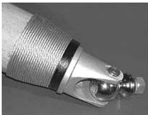
Il. 9. System łączenia pni bambusowych z elementami stalowymi opracowany i udoskonalany na Uniwersytecie w Bogocie w Kolumbii przez prof. RaulaRodrígueza. Źródło: [7]
