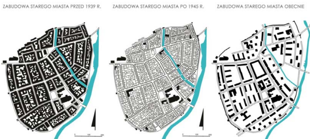
Ryc. 5. Plan obszaru Starego Miasta w Chojnie. Schematy planu obszaru miasta średniowiecznego Chojna w woj. zachodniopomorskim ukazują trzy fazy miasta: miasta zwarteo, o ścisłej zabudowie, jaka istniała do czasu przejścia przez miasto frontu wschodniego pod koniec II wojny światowej, miasta zburzonego wg stanu, jaki zastały władze polskie po r. 1945, miasta współczesnego o częściowo odbudowanej strukturze. Oprac. WBiA ZUT w Szczecinie
