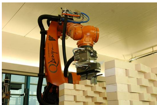
Ryc. 5. Robot KUKA układający elementy modułarne. Źródło: http://www.dfab.arch.ethz.ch/web/e/forschung .
