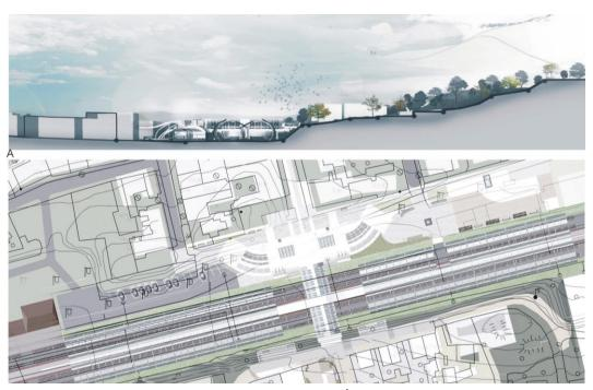
Ryc. 9. Rzut i przekrj projektowanego przejscia nad torowiskiem. Źródło: il. S. Holotovskyy, 2016. Fig. 9. The project proposal of architectural and spatial solutions of over-ground overpass and noise screens. .. Source: il. by S. Holotovskyy, 2016.
